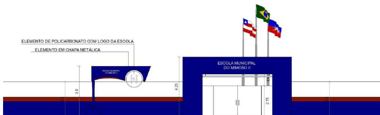
Imagem pórtico e totem padrão – fachada principal.
