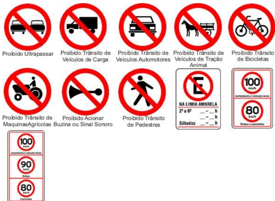
Figura 7.5 – Placas de sinalização de regulamentação de acordo com o CTB
