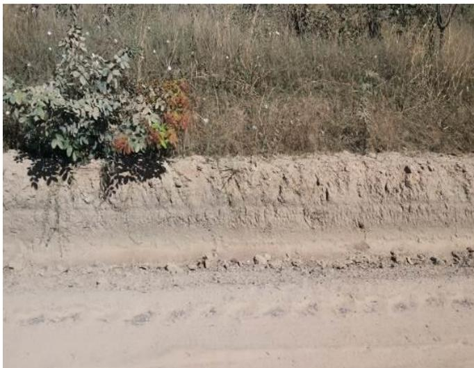
**FOTO 4.4** - Corte lateral do solo na região do futuro aterro mostrando a ocorrência de solos arenosiltosos, que não poderão ser utilizados na camada de impermeabilização do aterro.
