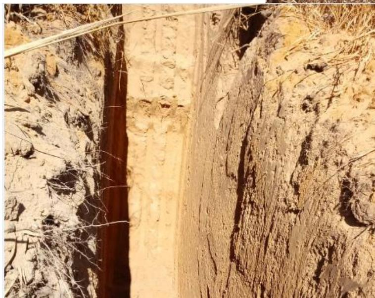
**FOTO 5.9** - Poço de inspeção executado para verificação do perfil geológico e coleta de amostras na área do aterro, na base de uma das células.
