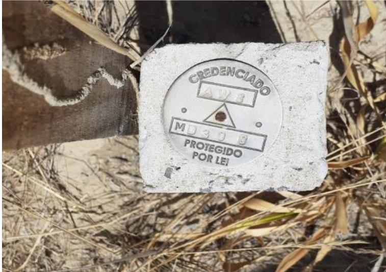
**FOTO 5.2** - Detalhe do marco topográfico existente e cadastrado pela equipe da GEOTECHNIQUE.
