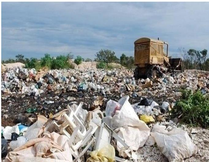
**FOTO 4.13** - Trator de esteira fazendo o espalhamento dos resíduos lançados no lixão, sendo este serviço realizado em alguns períodos do ano.
