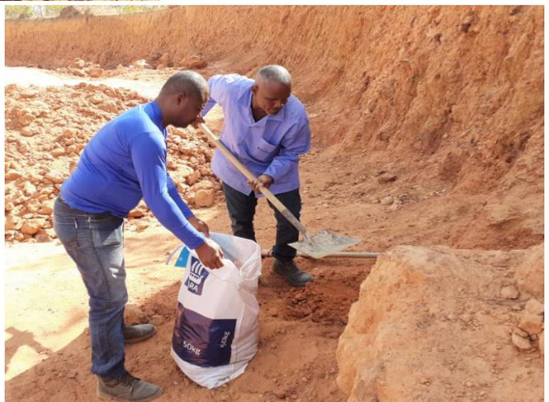
**FOTO 5.6** - Coleta de amostras de solos argilosos na Jazida 02 de particular situada nas proximidades na BR-242 a 5,4 km do local do aterro.
