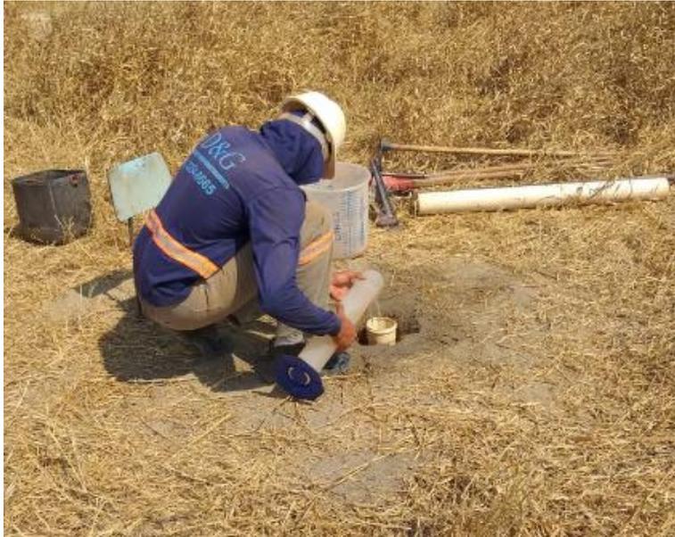
**FOTO 5.10** - Ensaios *in situ* de infiltração de água na base de uma das células.
