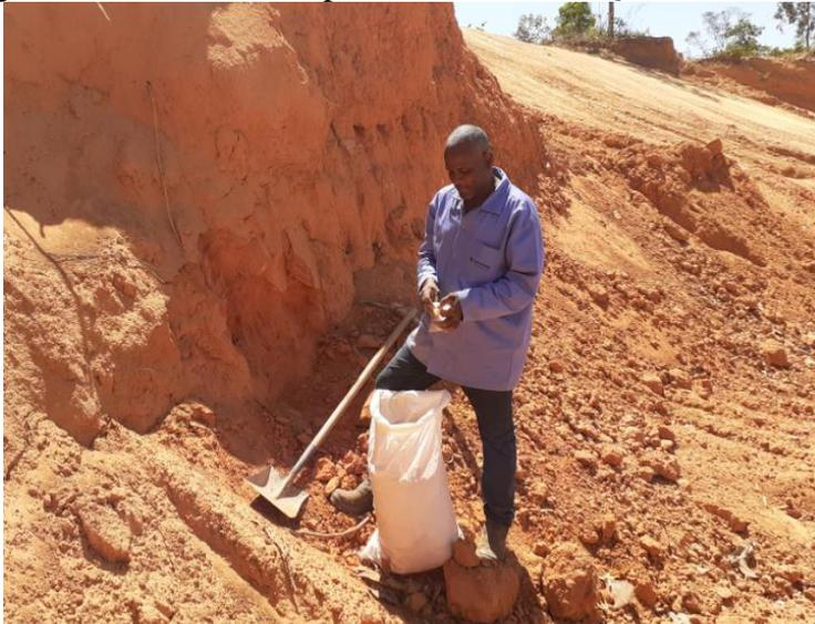
**FOTO 5.5** - Coleta de solos argilosos na Jazida 01 da Prefeitura, indicada para impermeabilização das células.
